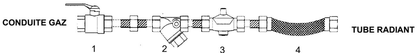
**IMPORTANT :** Lors du raccordement gaz à l'appareil, il faudra veiller à ne pas trop serrer afin de ne pas faire pivoter la rampe gaz dans le caisson brûleur !
