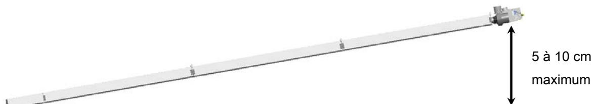
Pour le montage en position inclinée : respecter une inclinaison maximale de 30°, **extracteur en haut**. L'évacuation de l'extracteur se fait à la verticale pour faciliter le raccordement des conduits de cheminée.
