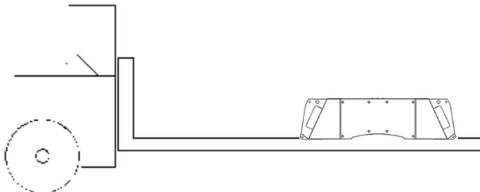
Dans tous les cas prendre garde à ne pas endommager les réflecteurs : positionner des protections en carton sur les fourches.
