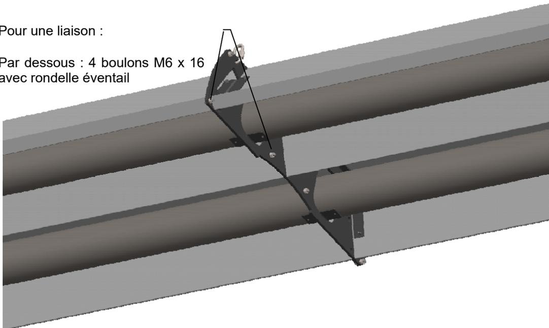
Poser le réflecteur du coude, vérifier que le coude est en butée contre la traverse puis visser les 2 tubes sur la traverse côté coude dans les 2 trous prévus à cet effet (attention à ne pas visser les tubes sur les autres traverses)
