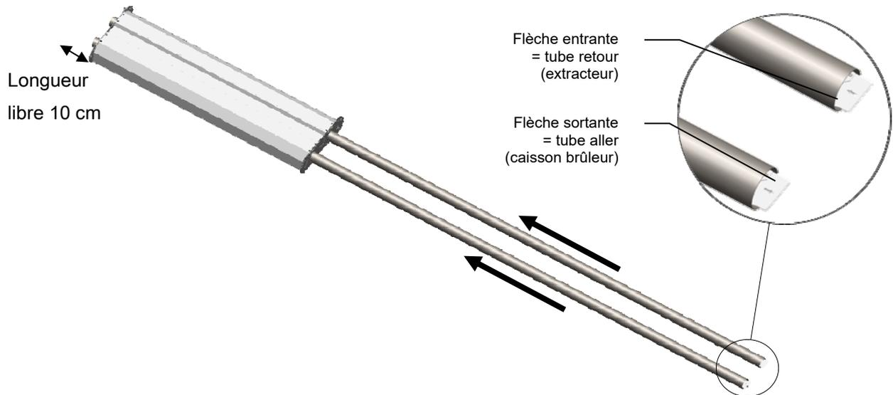
Enfiler les 2<sup>ème</sup> (SolarHPR23) et 3<sup>ème</sup> modules (SolarHPR36) sur les tubes
