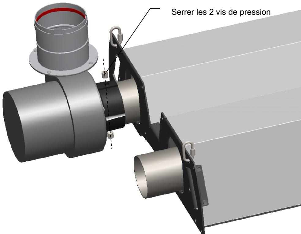
Insérer le caisson brûleur en butée sur le tube de droite.
