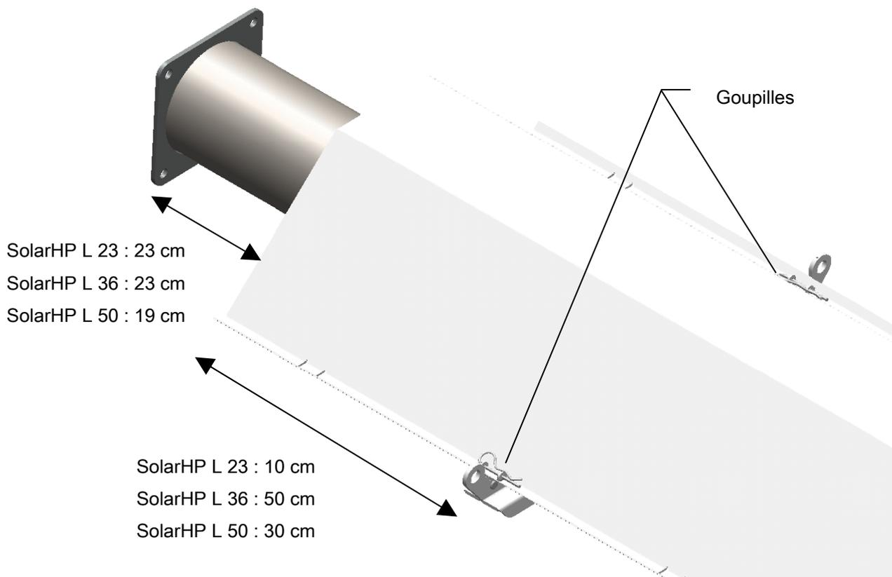
Poser les réflecteurs suivants en respectant les recouvrements indiqués dans le tableau ci-dessous.
