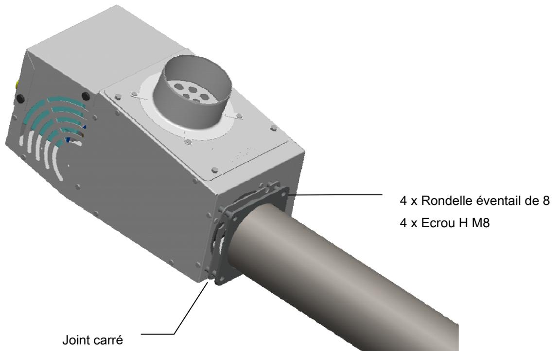
SolarHP L 50 : Visser l'extracteur sur la bride carrée du tube après avoir inséré le joint
