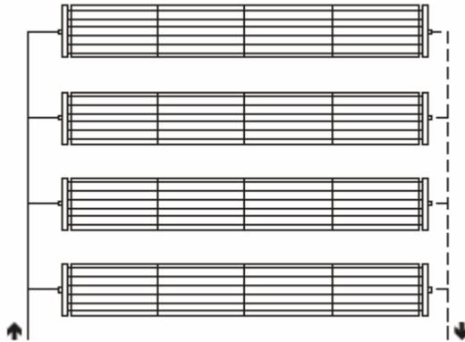
**Fig. 19** Panneaux radiants ECOPAN en parallèle avec connexions opposées
