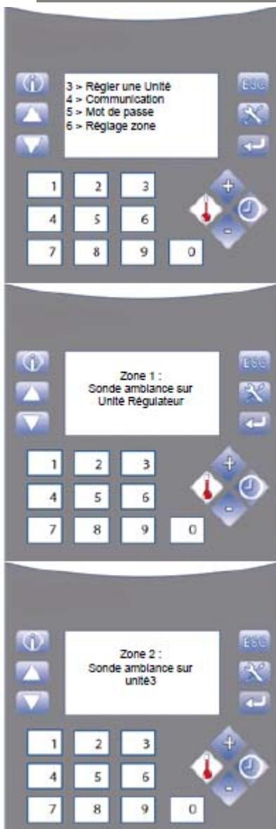
Quand 2 zones de régulation sont définies il est nécessaire d'installer 2 sondes de température ambiante. L'une au moins de ces sondes doit être raccordée à un aérotherme. Pour définir la position de cette sonde (ou des deux) utiliser la procédure suivante :
