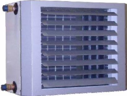
L'aérotherme SOLARONICS type AEC est un appareil de chauffage indirect fonctionnant à l'eau chaude et disponible en différentes puissances, allant de 13 kW à 87 kW pour de l'eau chaude 80/60 et l'air de reprise à 15°C.
