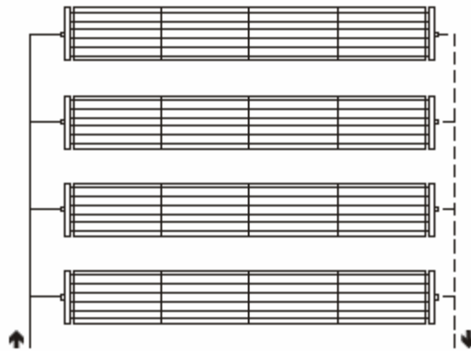
Fig. 19 Stralingspanelen ECOPAN in parallel met tegenovergestelde aansluitingen
